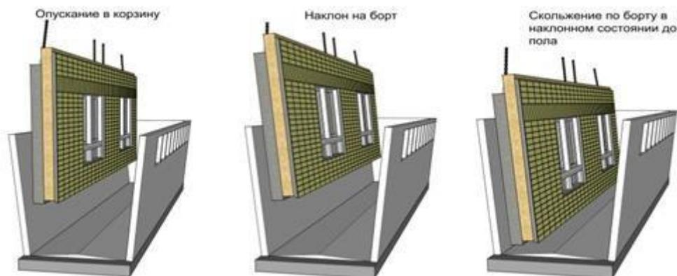
6. После погрузки стропальщиками грузов, получив от ответственного за безопасное производство работ с использованием подъемных сооружений на погрузочной площадке лица, устное разрешение подойти к транспортному средству, водитель панелевоза обязан убедиться в надежном и устойчивом для транспортировки размещении железобетонных панелей, закреплении стропальщиками панелей, имеющимися на панелевозе страховочными цепями за монтажные петли.
